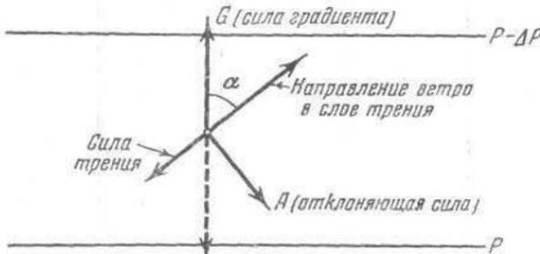
Рис. 53. Расположение действующих сил при ветре в слое трения
